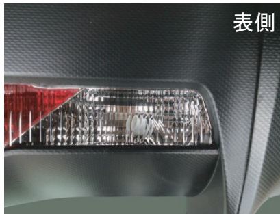
バックランプ灯体にダミーソケットを装着
